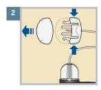
Retirez le capuchon blanc du connecteur du site en pressant les côtés du connecteur du site, puis en retirant le capuchon blanc Assurez-vous que la tubulure ne contient pas d'air
