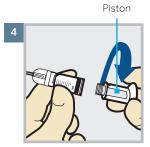
Tournez le piston dans le sens inverse des aiquilles d'une montre pour desserrer et retirer.
