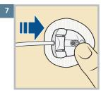
Maintenez délicatement le logement de la canule immobile avec le doigt. Poussez ensuite le connecteur du site droit dans le logement de la canule jusqu'à entendre un déclic. Éliminez l'appareil d'insertion dans un conteneur pour objets tranchants approprié et conformément à la réglementation locale.
