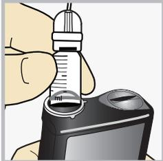
Setzen Sie das Reservoir in die Pumpe ein.
