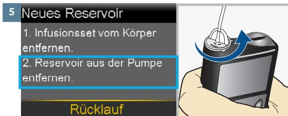
Entnehmen Sie das gebrauchte Reservoir aus der Pumpe.
